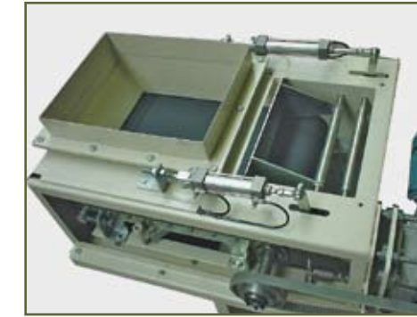
Detalle sistema de dosificación mediante cinta transportadora. Raseras de regulación de caudal y de corte Detail of the dosing system through belt conveyor. Flow and cut-off clamps
