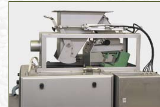
Dosificación mixta (gravedad + canal vibrante) Combined dosing system (gravity + vibrating tray)
